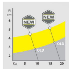
Neue Version mit identischer nützlicher Kochfläche und reduzierter Energiekraft. Eine Erhöhung der Ausbeute pro cm<sup>2</sup>, wodurch eine Verbrauchsreduzierung bis zu 15% im Vergleich zu herkömmlichen Versionen möglich ist
